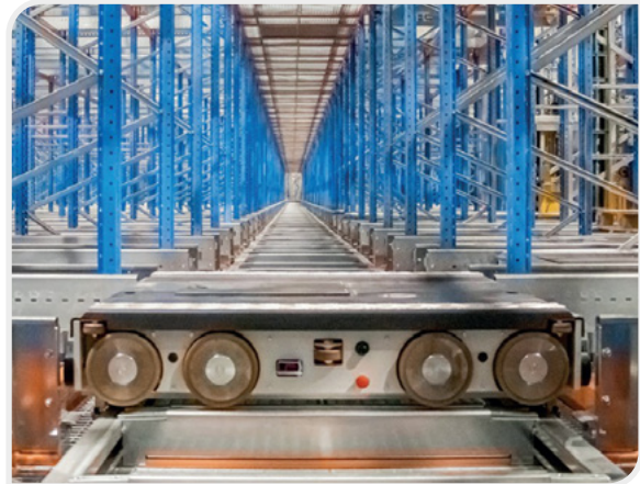
Fot. 2. // Wózek typu robot AGV (źródło: STOW)
