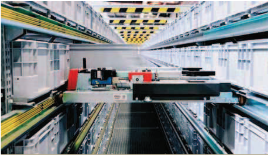
Rys. 2. Samojezdny wózek typu shuttle (fot. KNAPP AG)
