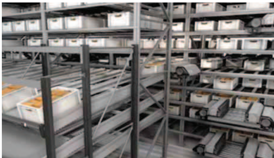
Rys. 3. Układ regałów przepływowych we wnętrzu systemu shuttle (fot. KNAPP AG)
