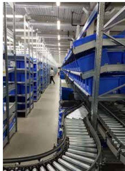
Fot. 2. Typowy układ regałów w stacjach kompletacyjnych w magazynie o niskim stopniu automatyzacji procesów kompletacyjnych z podziałem na produkty o różnej rotacji
