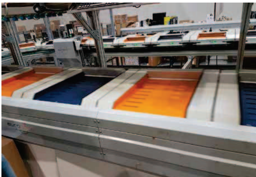
Fot. 2. Sorter ze spychaczem poprzecznym dla odzieży pakowanej w worki
