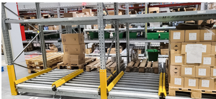
Fot. 2. Przykład wykorzystania regału paletowego przepływowego do procesu kompletacji często zmieniającego się asortymentu produktów szybkiej rotacji (źródło: materiały własne LLS)
