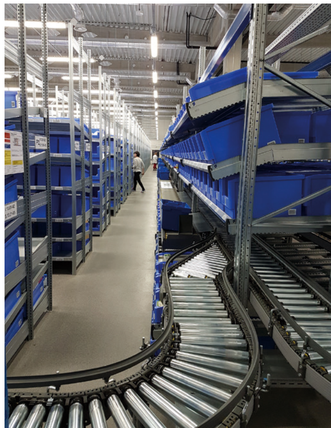
Fot. 3. Przykład konfiguracji regałowej strefy kompletacji z wieloma zakresami rotacji towaru (źródło: materiały własne LLS)
