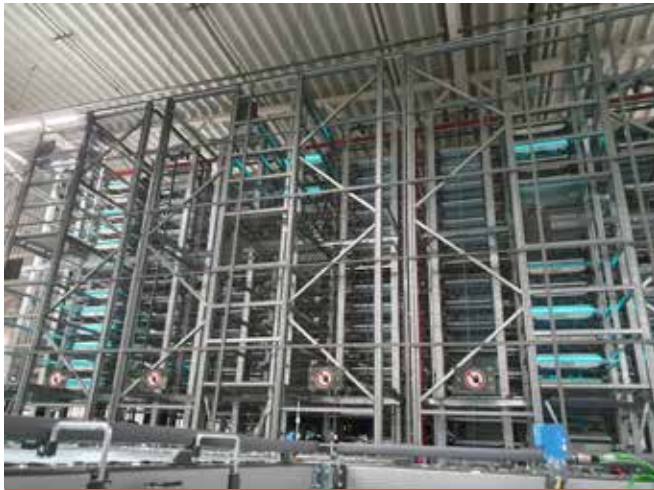
Złożony system automatyzacji magazynowej w postaci potężnych układów przechowywania i podawania do stacji kompletacyjnej pojemników (materiały własne LLS)
