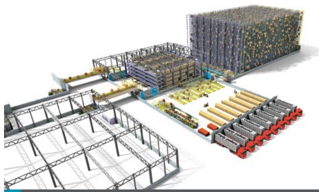
5 Układ typu SILOS
