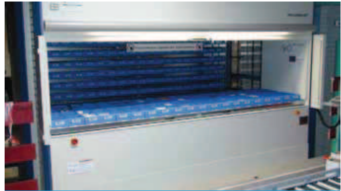
Fot. 3. Większe zagęszczenie magazynu uzyskano m.in. przez wykorzystanie regałów automatycznych typu Lean-Lift
